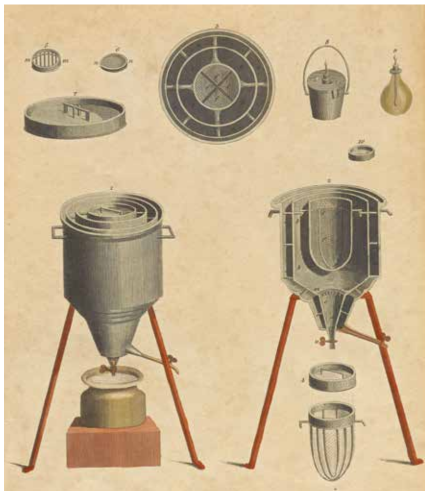
⤴ Kalorymetr skonstruowany przez Lavoisiera i Pierre'a Laplace'a, urządzenie do pomiaru ciepła wydzielanego bądź pobieranego podczas procesów fizycznych i chemicznych.
