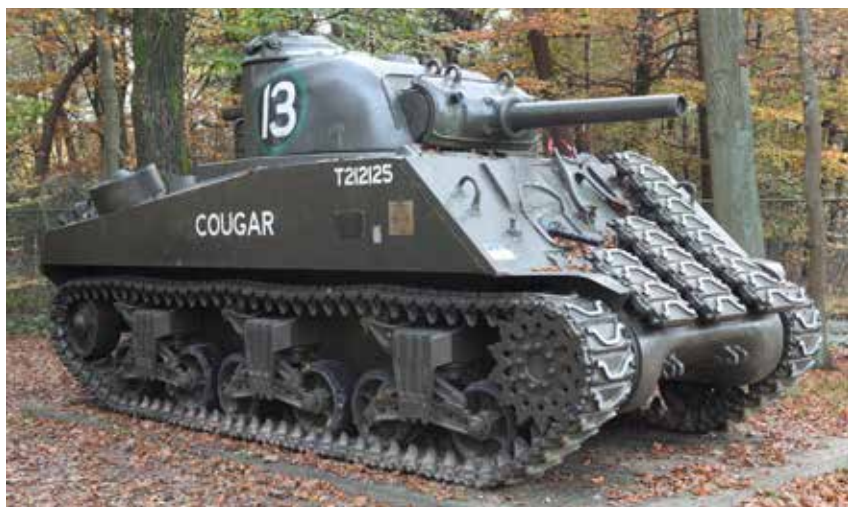
Czołg M4 Sherman. Pancerze tych wozów były spawane, a nie nitowane, a każdy kolejny model czołgu był podobny do poprzedniego. Dzięki temu mogły być szybko montowane. Fot. Joost J. Baker na licencji CC BY-SA 2.0
