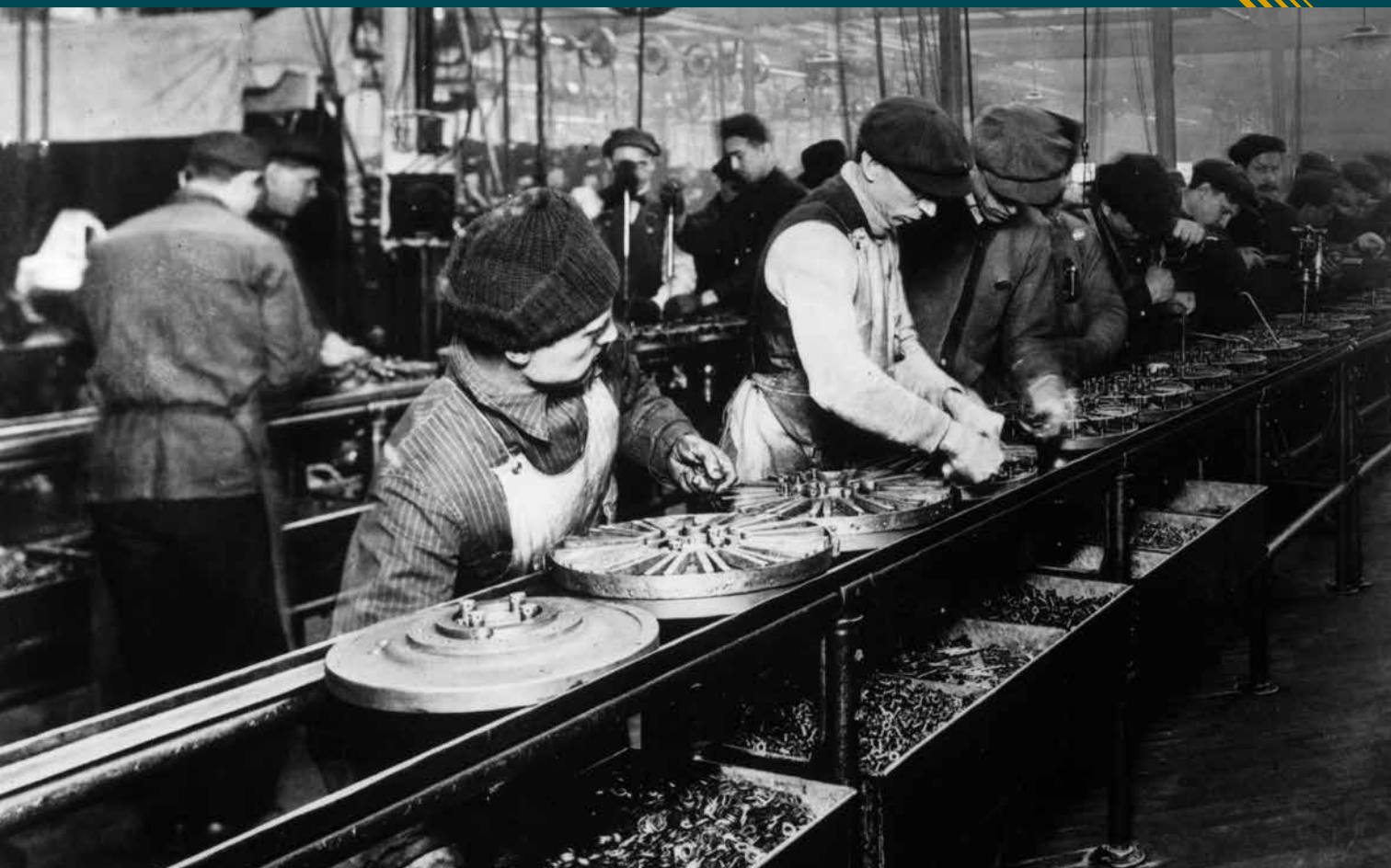
Linia montażowa w zakładach Forda. Amerykański generał i biznesmen William Knudsen przekonywał Roosevelta, że każda fabryka produkująca samochody może wytwarzać pojazdy wojskowe. Wystarczy podzielić pracę na wiele drobnych czynności i zadbać o odpowiedni nadzór nad robotnikami. Fot. Wikimedia Commons
